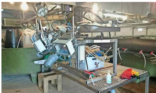
Abb. 2: Vollautomatisierter Impfapparat für die intraperitoneale Impfung von Fischen.
