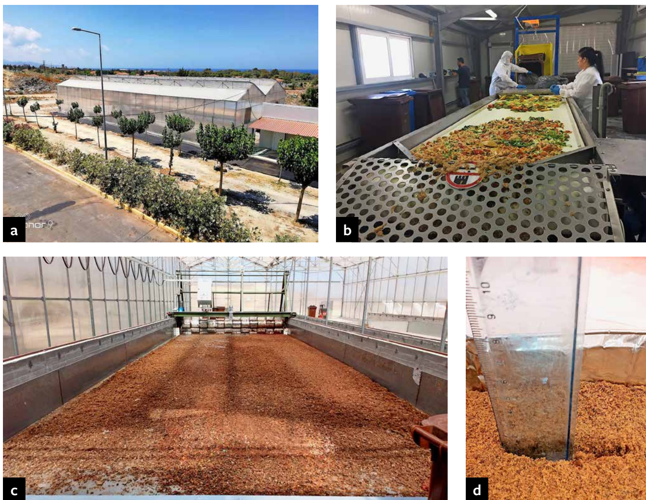
Abb. 1: Die „Pilot Unit“ in Heraklion (A), in der die gesammelten Speisereste sortiert (B), zerkleinert und mittels Solarenergie getrocknet wurden (C). Am Ende lagen die Speisereste mit einer Partikelgröße < 5 mm vor (D). Die getrockneten Speisereste wurden in die Rationen für die sich anschließenden Fütterungsstudien eingemischt.
